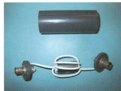
Strömdrossel med nio varv koaxial-kabel på en ferritkärna.
