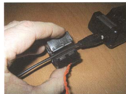
Störkontroll med ferritklämma.
