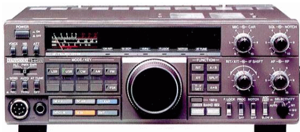
Kenwood TS-440, HF allmode (2.900 kr) Endast transceivern ingen nätdel. Med CW filter och riggstyrningsinterface.
