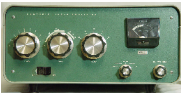
Heathkit SB-200, 600 W HF slutsteg (3.000 kr) Fräscha rör och ny HV-diodbrygga.
