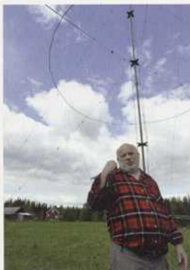
Die Multiband-Antenne deckt den Bereich von 3 bis 30 MHz mit exzellenten Resultaten ab.
